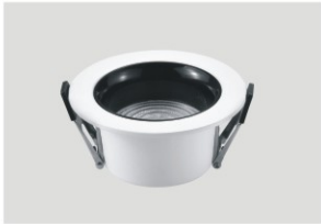
名称: 高光效防眩筒灯 功率: 2.5寸9W 尺寸: 98*H45mm 开孔: ø75-90mm 色温: 白光/中性光/暖光/变光 颜色: 砂白(配黑杯/白杯)
