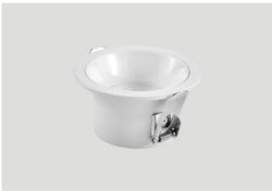
名称: 高光效防眩筒灯 功率: 2.5寸9W 尺寸: 85*H45mm 开孔: ø75mm 色温: 白光/中性光/暖光/变光 颜色: 全白(配白杯)
