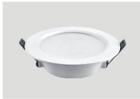
名称: 压铸铝筒灯 功率: 3.5寸-12W 尺寸: 122*H31mm 开孔: ø95mm 色温: 单色/白光/中性光/暖光 颜色: 白漆
