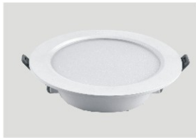
名称: 压铸铝筒灯 功率: 4寸-18W 尺寸: 138*H32mm 开孔: ø115-120mm 色温: 单色/白光/中性光/暖光 颜色: 白漆
