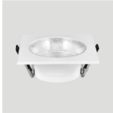
名称: 方形防眩筒灯 功率: 3.5寸-15W 尺寸: D120*120*H46mm 开孔: 95*95-110*110mm 色温: 单色 颜色: 白色/黑色
