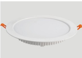
名称: 压铸铝筒灯 功率: 8寸-30W 尺寸: 230mm 开孔: ø190-210mm 色温: 白光/中性光/暖光 颜色: 白色/黑色
