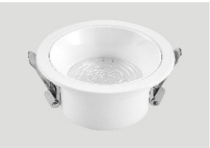
名称: 高光效防眩筒灯 功率: 4寸20W 尺寸: 135*H50mm 开孔: ø120mm 色温: 白光/中性光/暖光/变光 颜色: 全白(配白杯)
