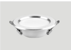
名称: 冲压铝筒灯 功率: 2.5寸-6W 尺寸: 100mm 开孔: ø75mm 色温: 变光/白光/中性光/暖光 颜色: 全白/白+银
