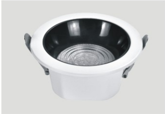
名称: 高光效筒灯 功率: 6W 尺寸: 90*H40mm 开孔: \varnothing 75mm 色温: 白光/中性光/变光 颜色: 白+黑杯
