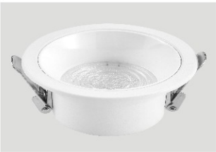
名称: 高光效防眩筒灯 功率: 6寸30W 尺寸: 170*H52mm 开孔: ø140mm 色温: 白光/中性光/暖光/变光 颜色: 全白(配白杯)
