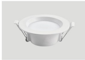
名称: 压铸铝筒灯 功率: 2.5寸-6W 尺寸: 98*H35mm 开孔: ø75-85mm 色温: 单色/白光/中性光/暖光 颜色: 白漆/黑漆
