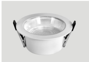
名称: 高光效防眩筒灯 功率: 3.5寸15W 尺寸: 120*H50mm 开孔: ø95-110mm 色温: 白光/中性光/暖光/变光 颜色: 砂白+透明杯
