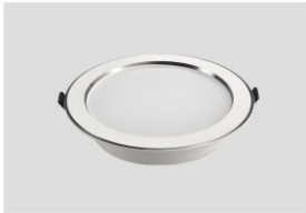
名称: 星雅筒灯 功率: 3.5寸-15W 尺寸: D115*H32mm 开孔: \varnothing 95mm 色温: 白光/中性光/暖光/变光 颜色: 白+金边/白+银边
