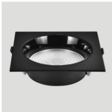
名称: 方形防眩筒灯 功率: 6寸-30W 尺寸: D165*165*H50mm 开孔: 135*135-150*150mm 色温: 单色 颜色: 砂黑+亮黑杯
