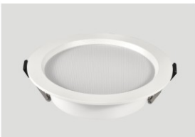
名称: 星雅筒灯 功率: 4寸-20W 尺寸: D142*H33mm 开孔: \varnothing 120mm 色温: 白光/中性光/暖光/变光 颜色: 白漆
