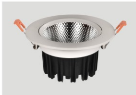
名称: COB天花灯 功率: 6寸-20W 尺寸: \varnothing 176*H75mm 开孔: \varnothing 150mm 色温: 白光/中性光/暖光 颜色: 哑白
