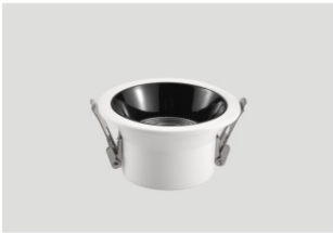
名称: 高光效防眩筒灯 功率: 2.5寸9W 尺寸: 85*H45mm 开孔: ø75mm 色温: 白光/中性光/暖光/变光 颜色: 全白(配黑杯)
