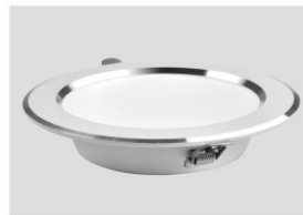
名称: 冲压铝筒灯 功率: 6寸-18W 尺寸: 180mm 开孔: ø140mm 色温: 变光/白光/中性光/暖光 颜色: 全白/白+银
