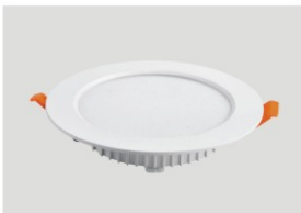
名称: 压铸铝筒灯 功率: 4寸-12W 尺寸: 145mm 开孔: ø115*130mm 色温: 白光/中性光/暖光 颜色: 白色/黑色
