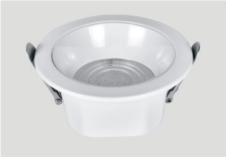
名称: 高光效筒灯 功率: 6W 尺寸: 90*H40mm 开孔: \varnothing 75mm 色温: 白光/中性光/变光 颜色: 白+白杯
