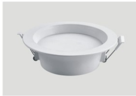
名称: 压铸铝筒灯 功率: 3.5寸-9W 尺寸: 118*H35mm 开孔: ø95-110mm 色温: 单色/白光/中性光/暖光 颜色: 白漆/黑漆
