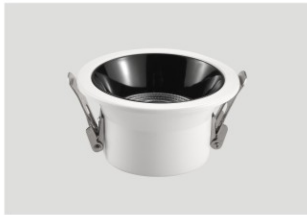
名称: 高光效防眩筒灯 功率: 3.5寸15W 尺寸: 110*H48mm 开孔: ø95mm 色温: 白光/中性光/暖光/变光 颜色: 全白(配黑杯)
