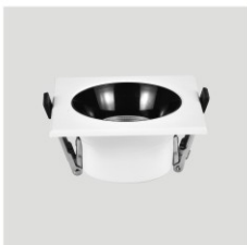
名称: 方形防眩筒灯 功率: 2.5寸-12W 尺寸: D95*95*H43mm 开孔: 75*75-85*85mm 色温: 单色 颜色: 砂白+亮黑杯
