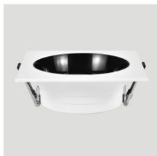
名称: 方形防眩筒灯 功率: 4寸-20W 尺寸: D145*145*H50mm 开孔: 120*120-130*130mm 色温: 单色 颜色: 砂白+亮黑杯
